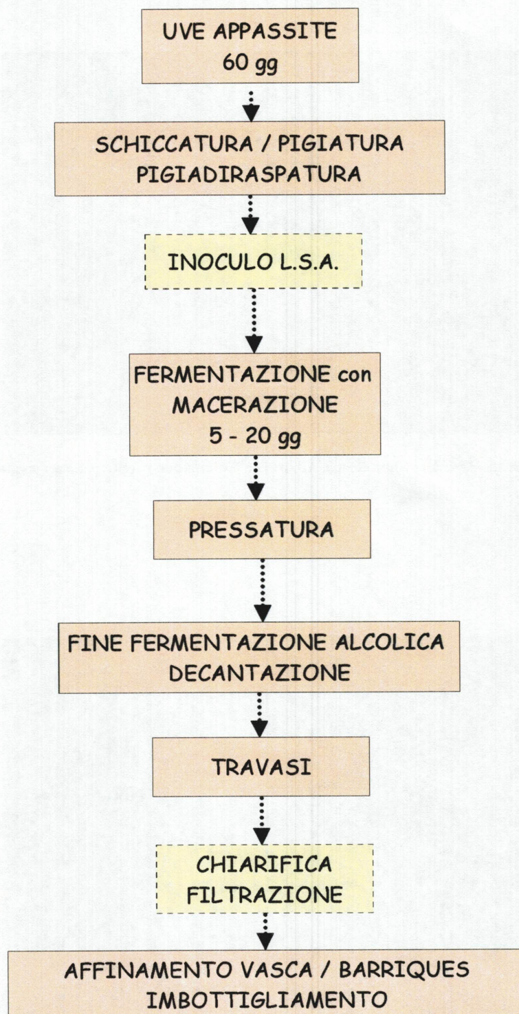
Figura 12 - Diagramma di flusso adottato per la produzione del Cinque Terre Sciacchetrà DOC. Le fasi riportate con un colore più chiaro ed il bordo discontinuo sono da considerarsi facoltative in quanto utilizzate solo da alcuni produttori
