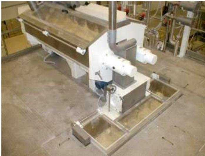
**Compressione** : l'impasto viene compresso in un cilindro con vite senza fine (vitone). Al termine la testata di diffusione che distribuisce l'impasto sulla trafila
