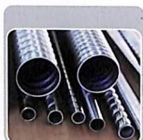
La corrugazione è una particolare lavorazione che viene effettuata sul tubo liscio al fine di ottenere una superficie interna in grado di creare una maggiore turbolenza termofluidodinamica nel moto del fluido permettendo di ottimizzare l'efficienza dello scambio termico negli scambiatori di calore tubolari.
