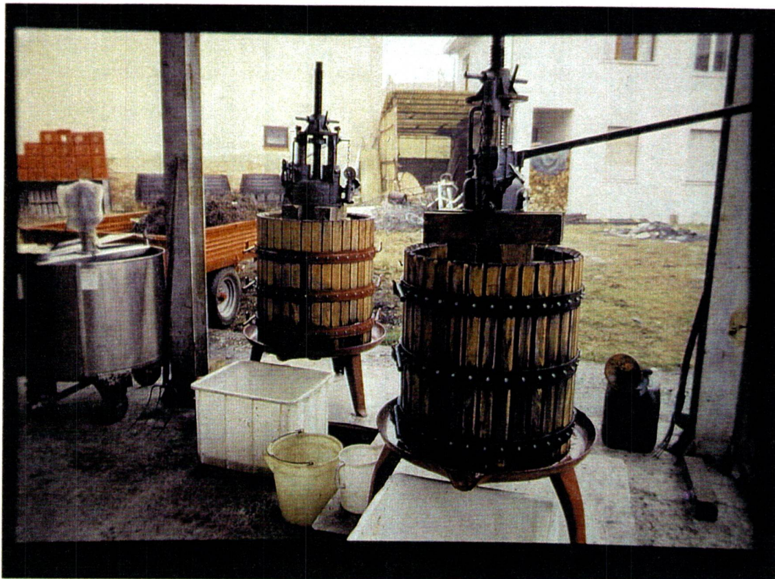
Fotografia 7 - Serie di torchi utilizzati per la pressatura delle uve di Erbaluce al termine della fase di appassimento
