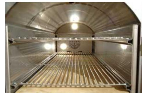
**Forni elettrici a IR ed a resistenze** → il riscaldamento è ottenuto mediante lampade IR o resistenze elettriche che riscaldano direttamente il prodotto o l'aria del forno. Non ci sono scarichi di gas combusti ma vi sono costi elevati di energia.
