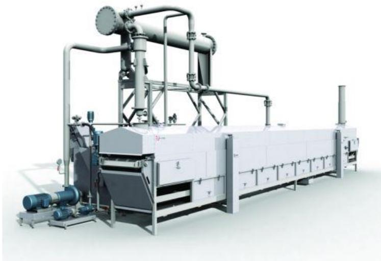
Dispositivi in cui il prodotto da trattare viene immerso in modo continuo nell'olio (manualmente od automaticamente) e trasportato nell'olio da un nastro trasportatore. Sono dotate di sistemi per allontanare gli scarti dalla camera di cottura.
