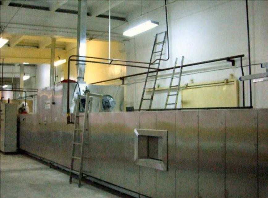
**Forni a combustibile a riscaldamento indiretto** → il bruciatore scalda l'aria che può passare all'interno delle pareti del forno, scorrere in radiatori sotto la platea di appoggio del prodotto, scaldare mediante degli scambiatori l'aria del forno.
