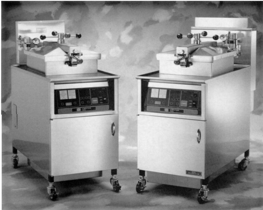
Si tratta di friggitrici ad immersione in cui si determina una sovrappressione nel sistema. L'aumento di pressione determina un aumento del punto di ebollizione dell'acqua e quindi non si forma uno strato di vapore fra prodotto e olio riscaldante: quindi aumenta lo scambio termico e diminuiscono le perdite di acqua dal prodotto.
