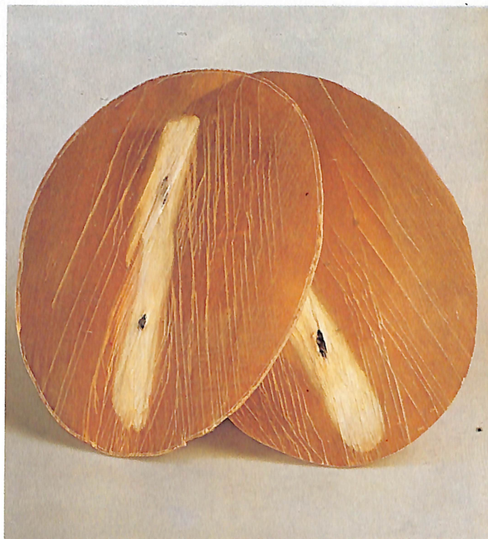
Porzioni di parete di serbatoi GIMAR su cui sono stati esplosi colpi d'arma da fuoco. Si può ben vedere come i proiettili siano stati arrestati dalla fittissima struttura di fibre di vetro impregnate con resina. Se si volesse procedere alla riparazione, l'operazione sarebbe semplicissima e ripristinerebbe completamente i manufatti.
