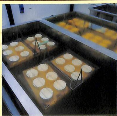
Pile di Forme su GRIGLIE per SALATURA immerse in VASCHE di Salamoia
