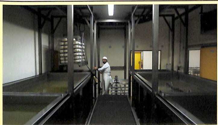
Operazione di immersione in Salamoia di forme impilate su GRIGLIE per SALATURA mediante PANCALE con TIRANTI
