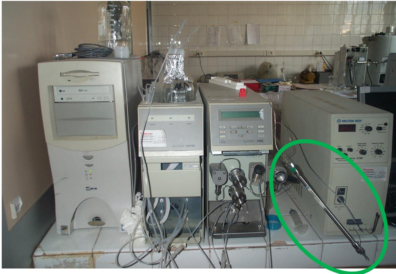
CONNESSIONI: le connessioni ed i tubi possono essere in acciaio inox o in PEEK (più comodo e facile da tagliare).
