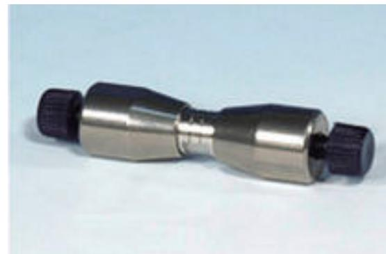
**PRECOLONNA:** è una colonna messa in testa alla colonna analitica, fatta dello stesso materiale della colonna, con la funzione di impedire il passaggio di eventuali impurezze o contaminanti. Viene sostituita periodicamente. Garantisce la protezione della colonna e ne allunga la vita. Provoca un aumento della contropressione.
