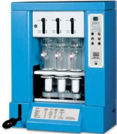
Un secolo dopo Randall combina l'estrazione in fase di vapore a riflusso con l'estrazione in fase liquida Soxhlet riducendo i tempi di estrazione.
