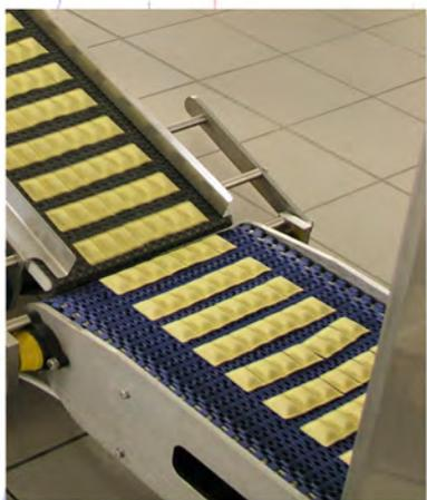
SPIRAX-385 rappresenta il primo modello di una nuova generazione di impianti a sviluppo verticale in IQP (Individual Quick Process) per pastorizzare, asciugare e raffreddare in un unico impianto in modo rapido e sicuro qualsiasi tipo di pasta, fresca e ripiena.
