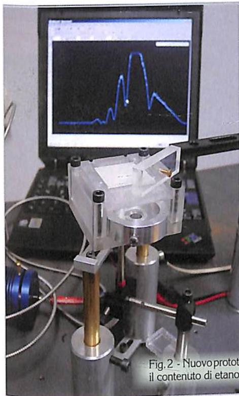
Fig. 2 - Nuovo prototipo per valutare il contenuto di etanolo nel vino
